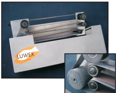
La legra es uno de vuestros instrumentos más utilizados. Debería estar afilado, ser funcional y fácil y rápida de afilar. Por ese motivo desarrolle esta maquina afiladora de gran calidad. Su base es de aluminio y de acero inoxidable con dos rodillos incorporados. ¡Un producto que dura décadas! Legras super afiladas en menos de 60 segundos!!
