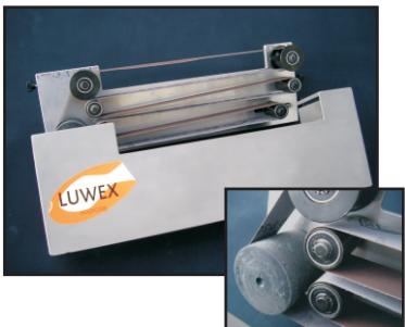
Das Hufmesser ist eines der meist gebrauchten Werkzeuge. Es soll "scharf", funktionell, schnell und einfach zu schleifen sein, deshalb habe ich diese Schleifmaschine entwickelt. Man kann eine Sache billig oder gut machen. Ich habe mich für Qualität entschieden. Aluminium-Edelstahlgehäuse, zweifach gelagerte Rollen. Ein Produkt für Jahrzehnte!
