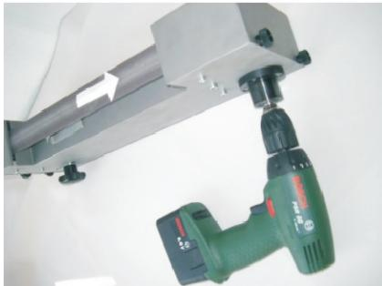
1. Attaccare un trapano a batterie o a filo al asse di trazione del nastro (direzione avanti). Scegliere la velocità bassa (c.a. 150 rivoluzione al minuto). In caso di trapano a filo conviene connettere la macchina a terra (filo di massa al telaio della tavola o della vettura).
